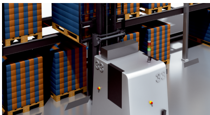
Контроль незаятости стелажного отделения автоматически управляемыми транспортными средствами
